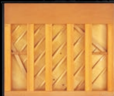
Six back post construction with European spruce soundboard Structure à six montants de barrage avec table d'harmonie en épicea européen
